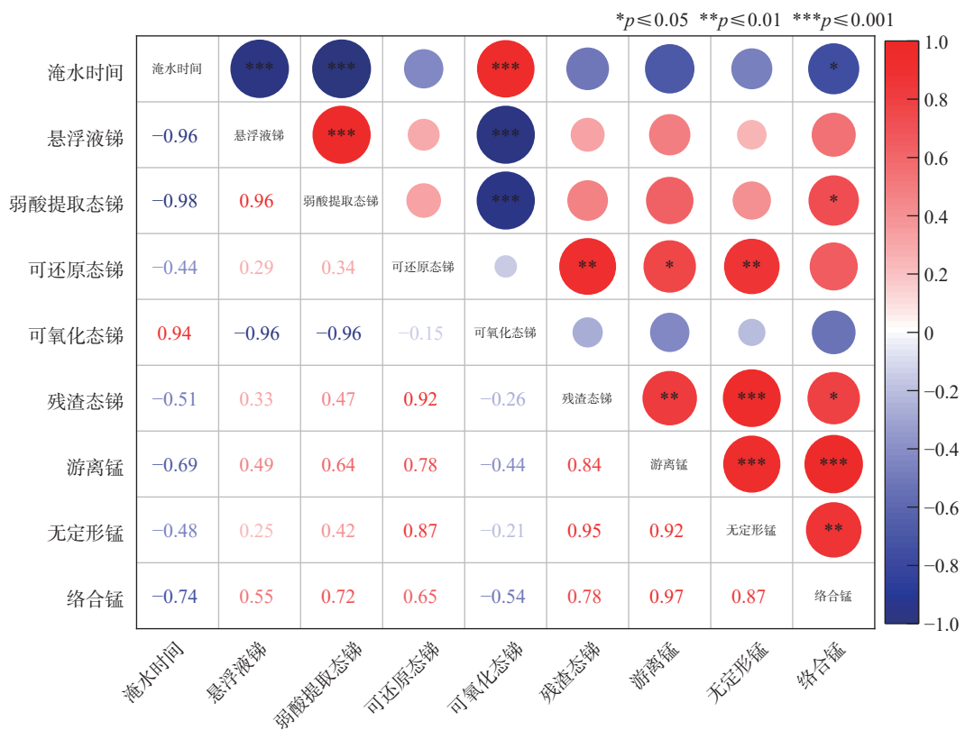
图8 淹水时间与土壤各形态锑、各形态锰之间的相关性分析结果(载锰土)
